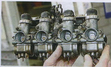
Met 89.000 km op de teller was het noodzakelijk de carburateurs te vervangen.
