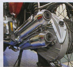
De Tyrra-oliebadkettingkast is er v... lijk voor dat nu al 230.000 km lang... ketting wordt gereden.
