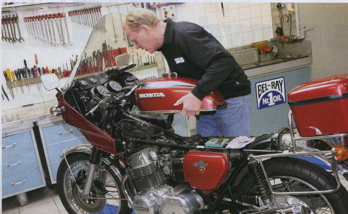
Buddy en tank zijn bij de CB750K2 in een handomdraai te verwijderen.
