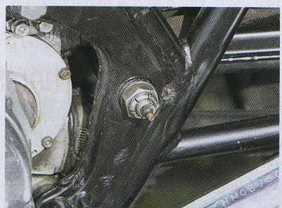
Ondanks de aanwezige smeernippel zijn de lagers van de achterbrug ver heen.
