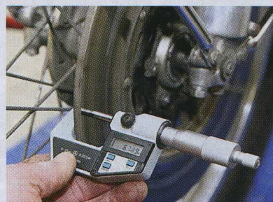
Na 260.000 km nog steeds dezelfde schijf waar... slechts 0,3 mm van af is gesleten. Weinig slij-... tage, maar helaas ook weinig remvermogen,... vooral bij nat weer.
